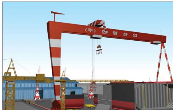
▶ 700ton goliath crane 설치예정
