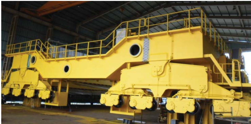
▲ 480톤 OVER HEAD CRANE 조립 사진
